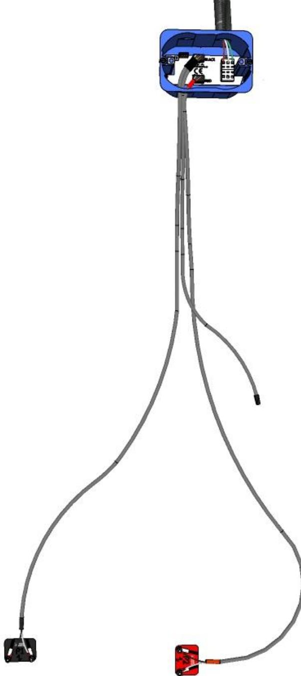
Ogni sensore ha la possibilità di leggere la temperatura del legno tramite una sonda di lunghezza 1 metro e l'umidità del legno tramite 2 sonde di lunghezza 3 metri per raggiungere i punti critici da monitorare\*.
